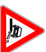
fig. 21 Art. 92 Banchina pericolosa
